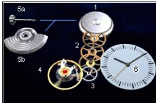
Mécanisme d'une horloge mécanique : la pièce n°1 est le ressort moteur
