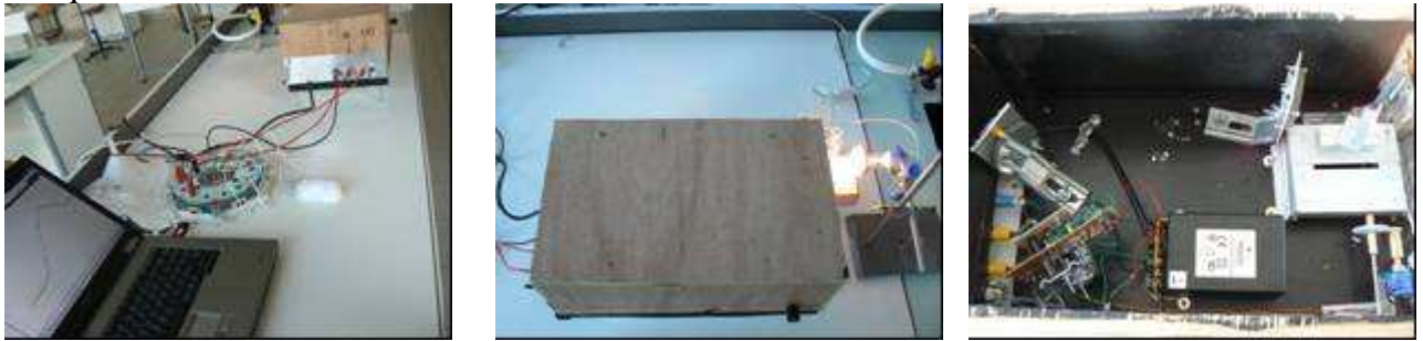
L'ensemble du spectroscopie et du système d'acquisition de données et vue intérieure
