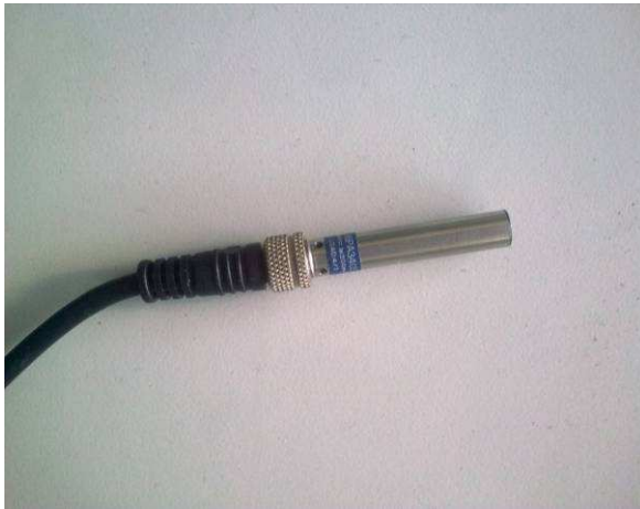
Fig.12 : Capteur à cellule inductive.
