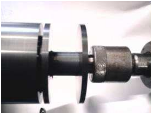
Fig.20a: Usinage des supports de bobines.
