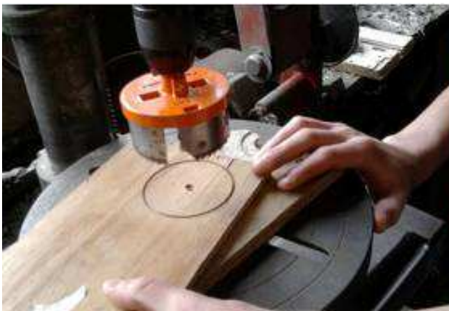
Fig.22a : Perçage d'un orifice pour ventilateur
