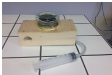
Chambre utilisant un système de dépressurisation
