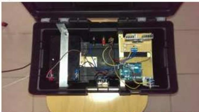
Le module de commande de la platine tournante
