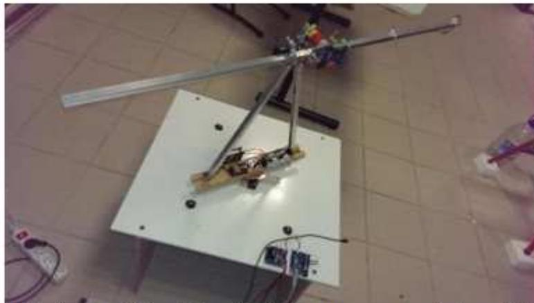
Ce dispositif permet d'obtenir un référentiel animé d'un mouvement de rotation dans lequel un objet possède une vitesse relative non nulle.
