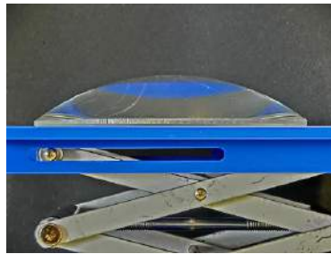
FIGURE 2.1 – Lentille convergente plan-convexe en verre
