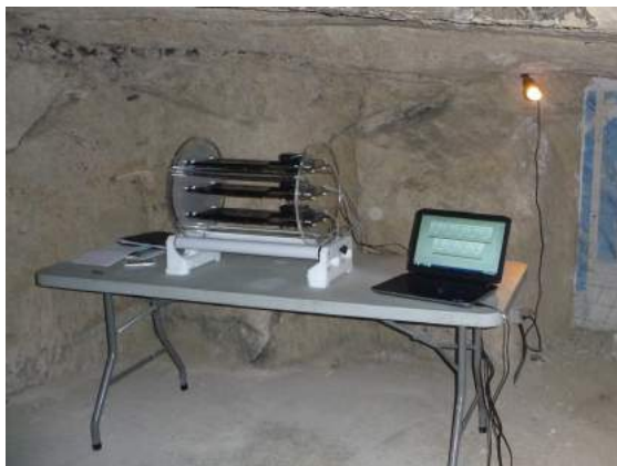
Figure 12 : Photographie du cosmodétecteur dans les caves de Benais
