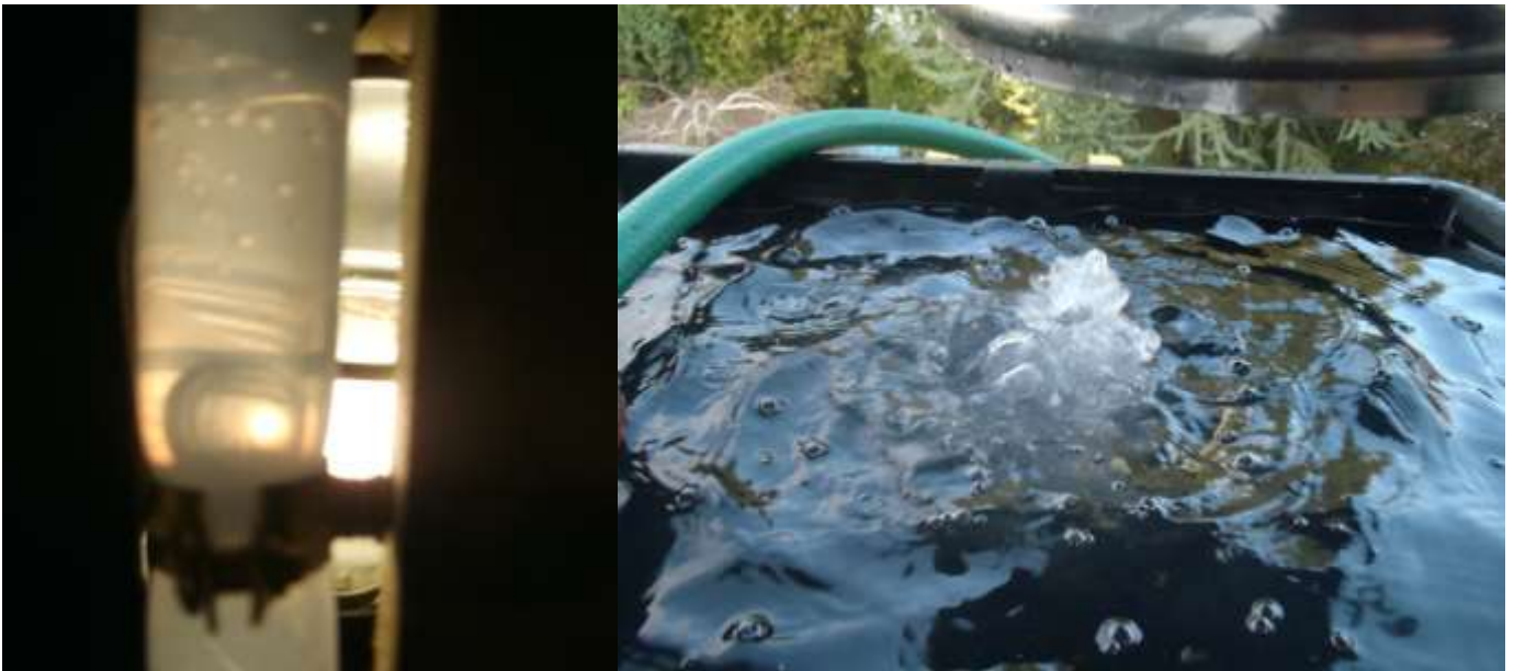
Figure AIII.1, AIII.2 : la vapeur remonte dans la colonne et l'eau jaillit dans la bassine au début de l'ébullition explosive.
