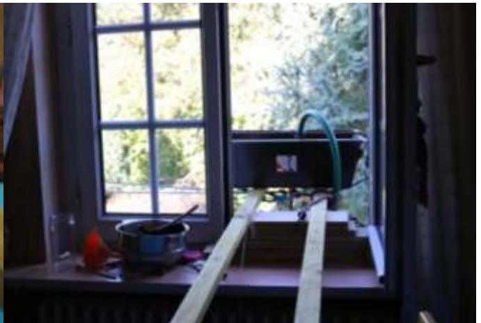
Figure All.2 : bassine réceptionnant l'eau à la verticale de la cocotte-minute.
