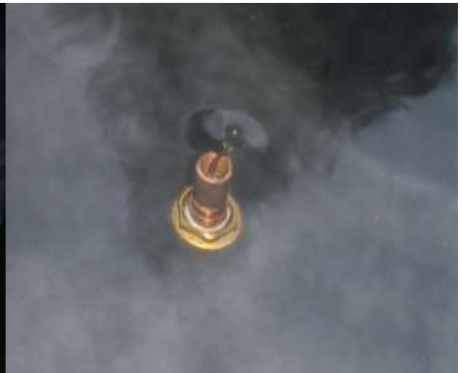
Figure AIII.4 : apparition d'un vortex lors de la dépression dans la cocotte-minute.
