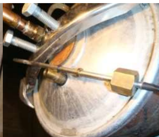
Figure All.6 : capteur de température et joints d'étanchéité.
