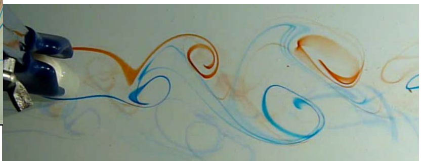
Figures 9 et 10 : Deux différents écoulements turbulents avec des allées de Von Karman
