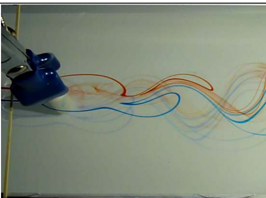
Figure 7 : Ecoulement laminaire avant insertion de l'obstacle
