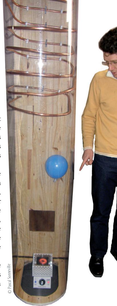
2. Un dispositif ingénieux : une colonne d'air, dont la partie haute est réfrigérée, modélise l'atmosphère. Une acquisition vidéo montre le ralentissement de l'ascension du ballon dans le haut de la colonne. (Lycée Jean Puy de Roanne).
