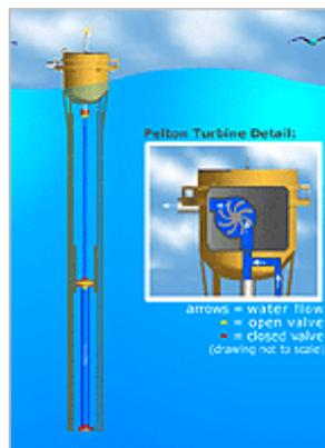
La firme **Interproject Service** présente sont "OWEC Buoy", qui fournit de l'énergie par compression verticale de deux pistons. Un peu comme le Pelamis (voir plus haut), qui lui fonctionne horizontalement en surface.
