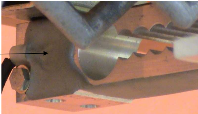
Photo n°4 : Les jauges de contrainte sous une couche de colle placées sur la partie métallique
