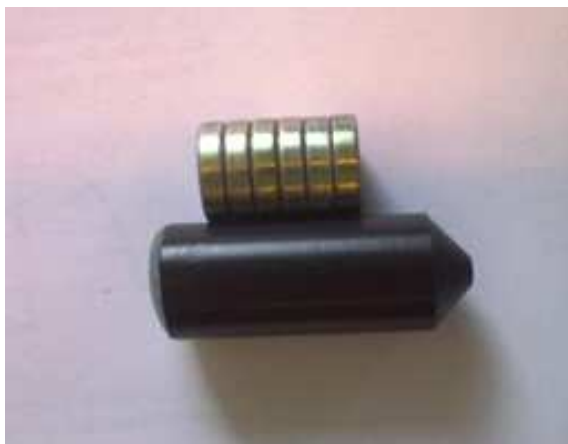
Fig. 6 : Au-dessus, une pile de six aimants « à nu » ; en-dessous, le « missile » de plastique contenant une pile identique.
