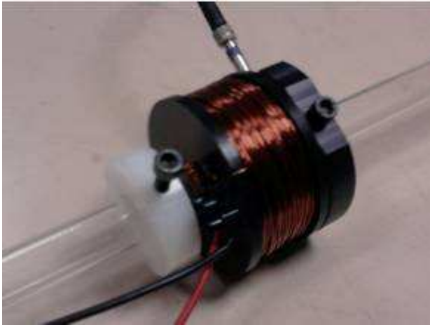
Fig.21: Un ensemble de bobine. De gauche à droite : une bague de serrage; la bobine dans son support ; un support de capteur.
