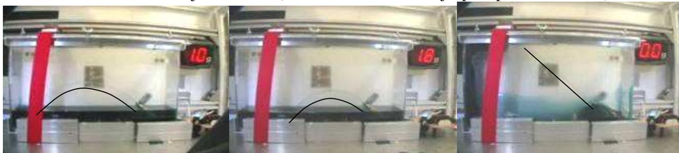
En phase de microgravité on observe un jet rectiligne.
