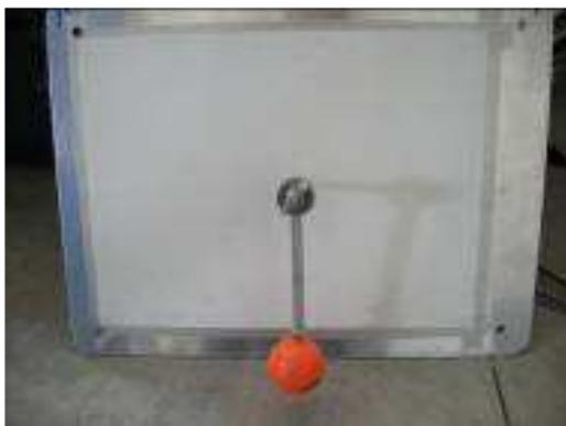
A l'aide du logiciel régavi, on pointe les positions successives du centre la balle de golf, puis on transfère les valeurs dans le logiciel regressi. On obtient les deux courbes suivantes.
