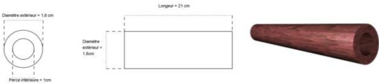
Figure 4 : Cotes et vue tridimensionnelle du conduit
