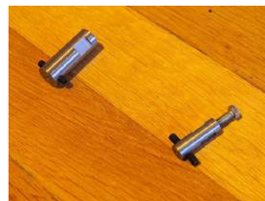
Fig 12: Photo du mécanisme permettant de retenir le fil tenant la boule
