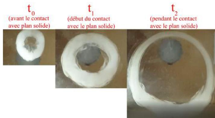
FIGURE 2.3 – Photos à différents instants de la collision d'un vortex avec une paroi
