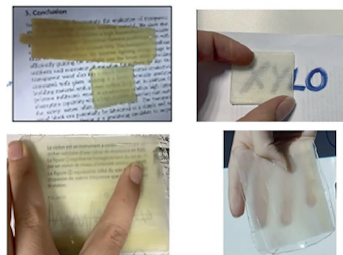
4. La réalisation du bois translucide.
