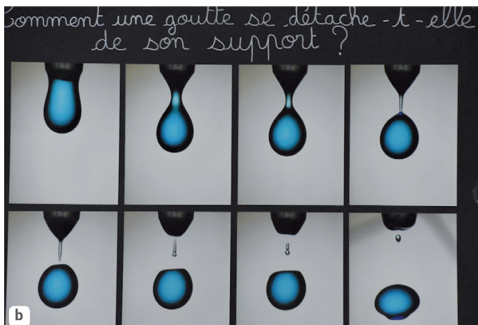
5. (a) Un dispositif très réfléchi pour étudier les gouttes. (b) Photomontage présentant le détachement d'une goutte d'eau (de diamètre \sim 2 mm) observé à l'aide d'une caméra à grande vitesse (400 images par seconde) ; la formation du pincement et le détachement réel de la goutte ne durent chacun qu'environ 2 à 3 ms. Sur les photos du bas, remarquer la formation d'une goutte satellite.
